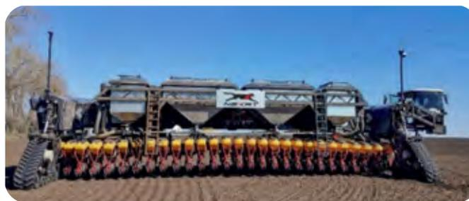
Figura 3 – Veículo equipado com módulo para realizar semeadura de precisão. Foto: NEXAT GmbH [www.nexat.de](http://www.nexat.de)
