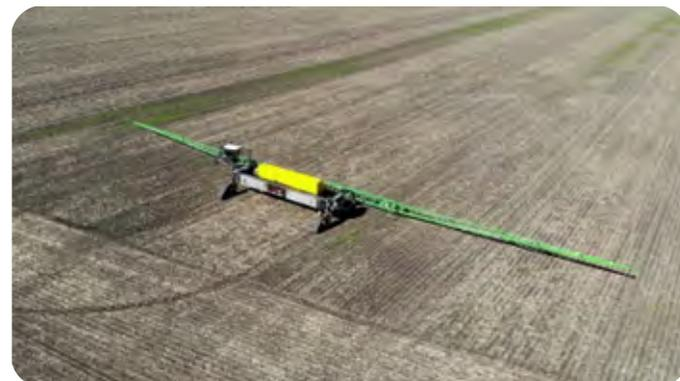
Figura 5 – Veículo equipado para realizar operação de pulverização. Foto: NEXAT GmbH [www.nexat.de](http://www.nexat.de)
